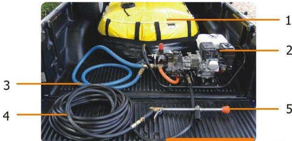
**1- Tanque flexible:** de perfil bajo, con quebra ondas para una mayor estabilidad del vehículo. Fabricado en PVC con reforzado en la base y manijas para facilitar el transporte y a la asamblea.
